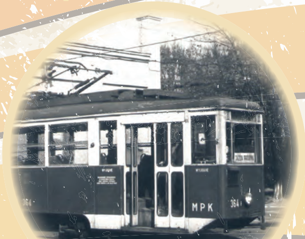
Tramwaj typu 5N, zmodernizowany ze starszego taboru, przed halą zajezdni Chocianowice, ok. 1975 r.
